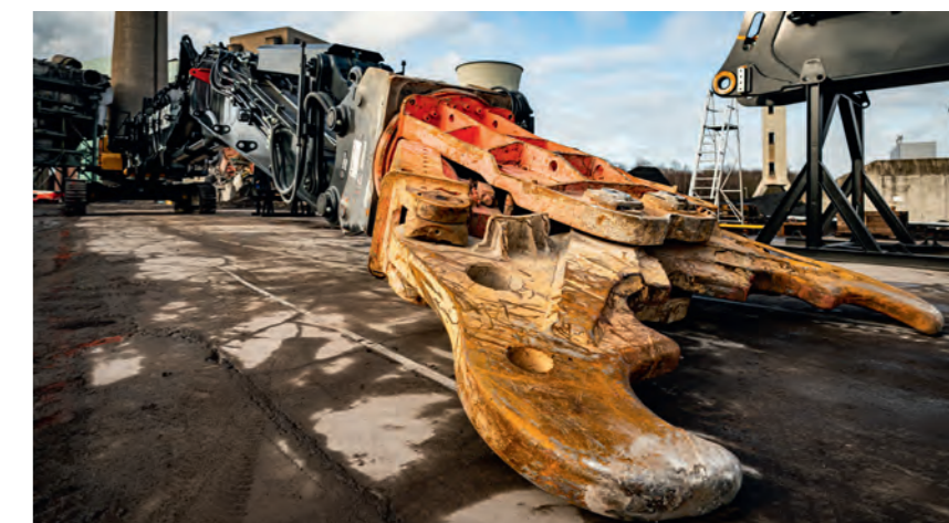
Einzigartige Abbruchzange: Die NPK SV 100XR schneidet auch in 36 Metern Höhe mit ihrer Maulbreite von über zwei Meter Stahl wie Butter.
